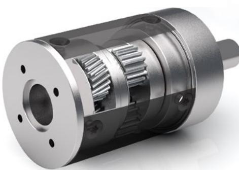
» **Baureihe PLG Planetengetriebe (PLG)** haben die höchsten zulässigen Dauerdrehmomente aller Getriebe bei gleichzeitig sehr kompakter Bauform, geringem Gewicht und ausgezeichnetem Wirkungsgrad. Bei unseren Planetengetrieben ist eine Vielzahl von verschiedenen Materialien je nach Kundenanforderungen kombinierbar, wobei Dauerdrehmomente bis zu 160 Nm betragen und Untersetzungen von 4:1 bis 710,5:1 erhältlich sind.
